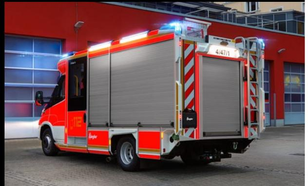
Flache Top Integro Kennleuchten auf der Fahrerkabine sorgen mit zwei an der Seite angebrachten LED-Blaulichtelementen und den Tailfin Heckkennleuchten für beste Sichtbarkeit im Straßenverkehr – auch für den Querverkehr. Die leistungsstarke LED-Umfeldbeleuchtung sorgt für eine optimale Ausleuchtung des Fahrzeugumfelds.
