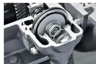
Der Maschinist muss nur Gas geben, der patentierte **Trokomat** mit nur wenigen Bauteilen entlüftet die Pumpe vollautomatisch.
